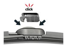
Remplacer la par la clip T150-TT. Assurez-vous de bien la clipser. Replace it with the T150-TT clip. Make sure you clip it well.
