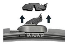
Retirer la clip interne sur l'adaptateur #1 Remove the internal clip on adapter #1
